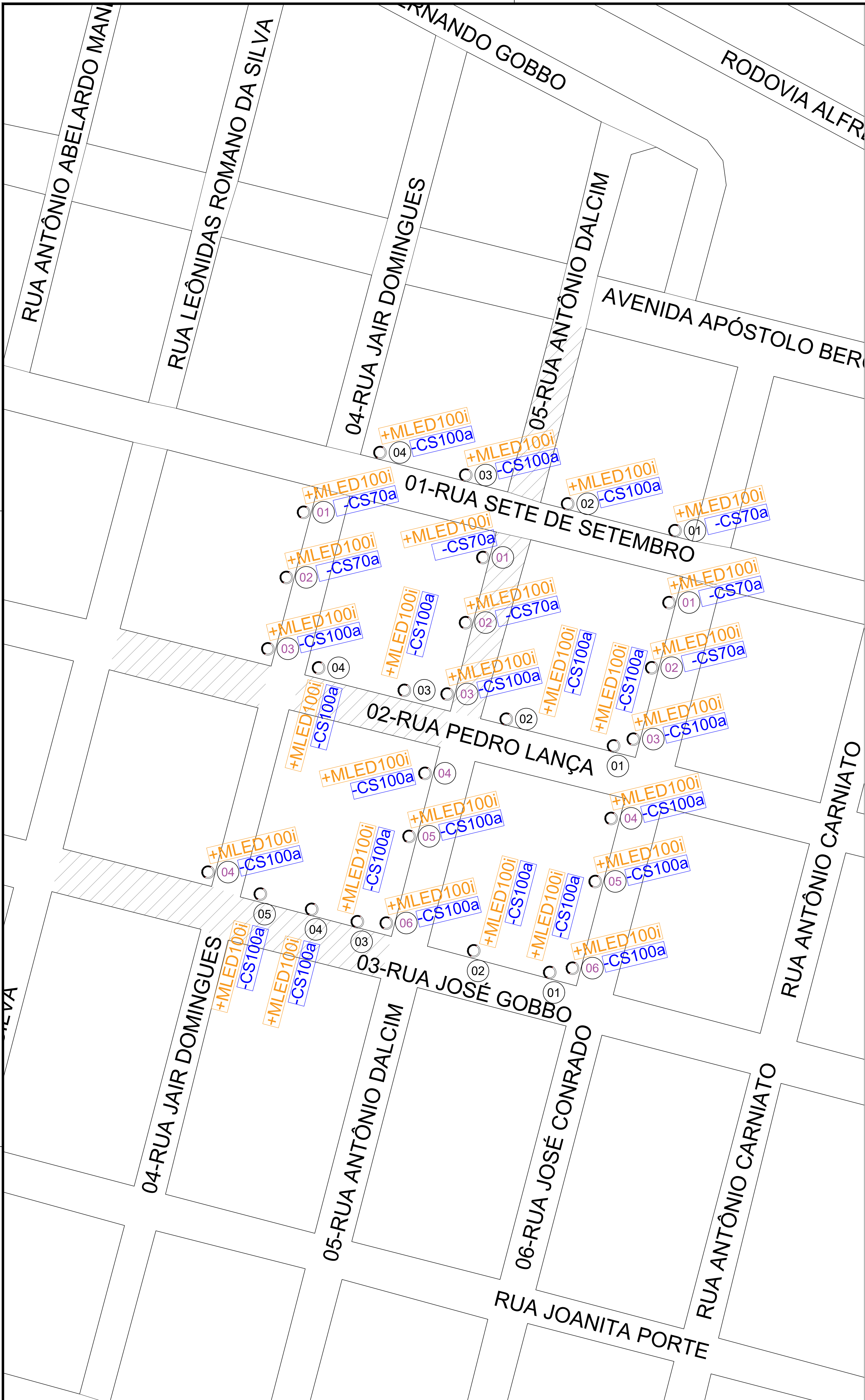
PLANTA DE PONTOS DE ILUMINAÇÃO ESC.: 1:700
